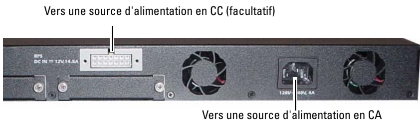
Figure 1-15. Connexion des câbles d'alimentation en CA et en CC à un commutateur
